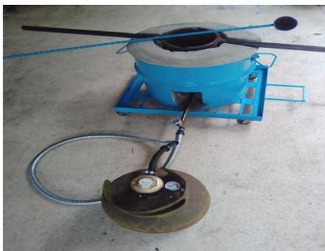
Gambar 3. Produk Tungku Pengecoran Logam Aluminium
